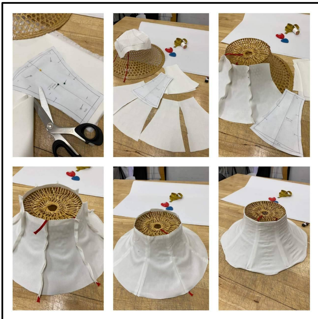
ภาพที่ 3 การวาดแพทเทิร์นโป๊ะโคมไฟ ทรงหมวกงอบ (ต่อ)
